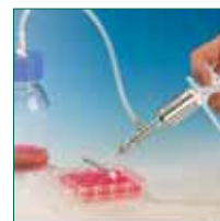
Aspirazione tramite valvola di modo inverso
