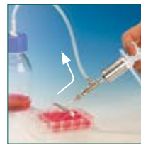
Aspiration mit Reverse Modus Ventil
