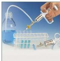
Filtración en la punta de la boquilla
