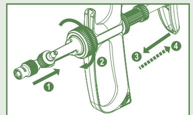
Gehäuse in gedrückter Position verbinden.
