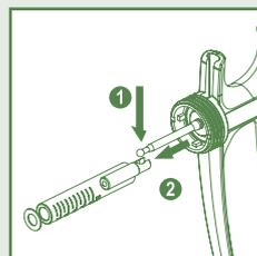
Kolben in den Zylinder
